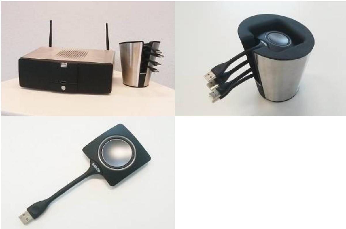
ClickShare ermöglicht es Inhalte von bis zu vier Endgeräten zu teilen und mittels Beamer auf die Leinwand zu übertragen.
