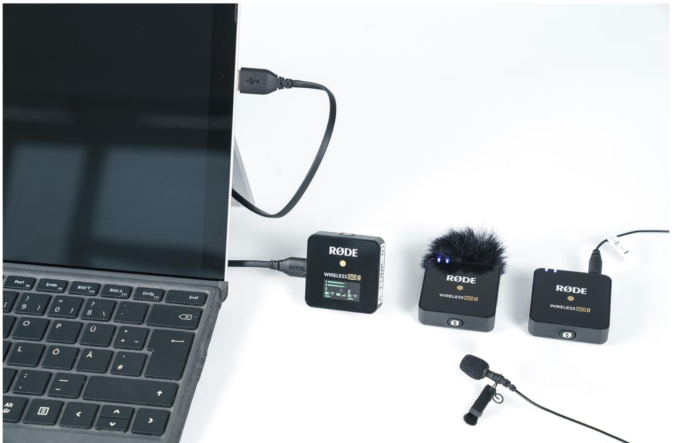
Das Rode Wireless GO kann direkt per USB-Kabel am Laptop angeschlossen werden
