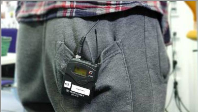
Das andere Ende des Kabels bringen Sie am Transmitter an. Üblicherweise werden die Transmitter hinten am Gürtel oder an einer Hosentasche befestigt.
