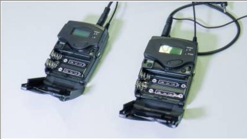
Öffnen Sie die Batteriekappen der Funkstrecken
