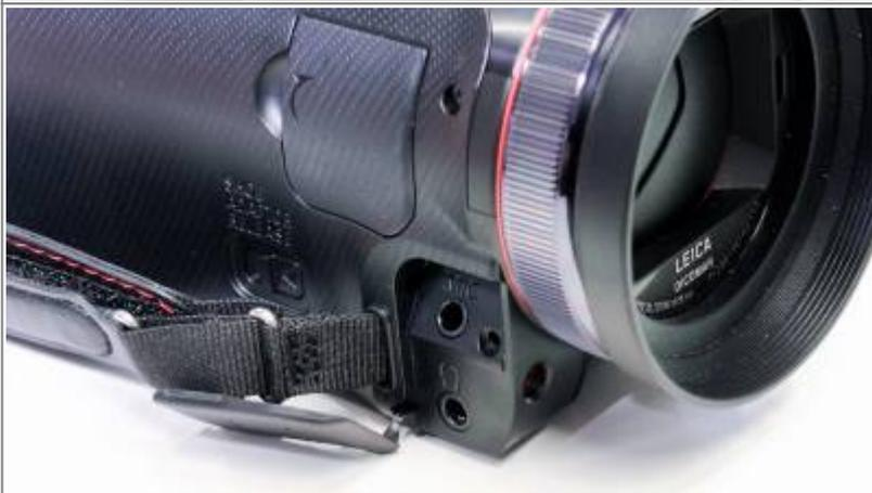
Schließen Sie den Receiver mit dem Klinke-Verbindungskabel an die Kamera an. Als Eingang wählen sie den MIC-Port
