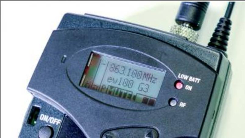
Ist das Gerät eingeschaltet, erscheint ein Display. Die Geräte sind voreingestellt und sollten bei beiden Geräten die gleiche Sendefrequenz anzeigen. Hier im Beispielbild: 863.100 MHz Solange nur ein Gerät eingeschaltet ist, erscheint der Schriftzug „MUTE“.
