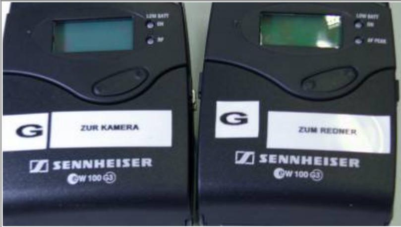
Die Funkstrecken bestehen aus einem Empfänger (Receiver), welcher an die Kamera angeschlossen wird, sowie aus einem Sender (Transmitter), an welchem das Mikrofon angeschlossen wird.
