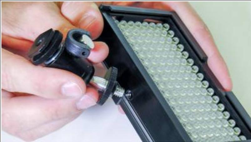
Schrauben sie den Adapter für den Schlitten an das Licht
