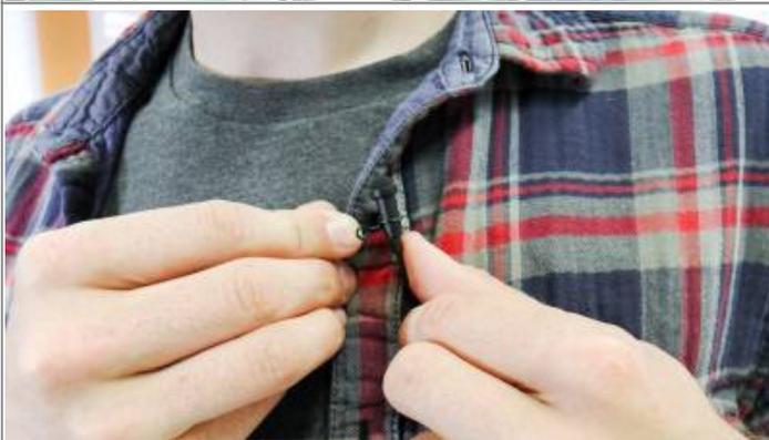
Bringen Sie das Lavalier-Mikrofon an einem Hemd, einer Krawatte oder einer Falte im Shirt an. Achten Sie darauf, dass das Mikrofon nicht mit Stoff in Berührung kommt (Störgeräusche, Kratzen). Das Mikrofon sollte in etwa auf der Höhe (Entfernung zum Mund) wie im Beispielbild angebracht sein.
