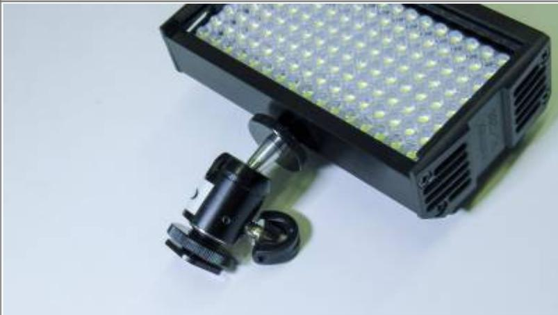
Drehen Sie die Scheibe zu, so dass sich das Licht an der Schraube nicht mehr von selbst bewegen kann.
