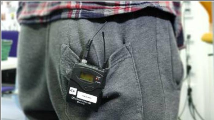
Das andere Ende des Kabels bringen Sie am Transmitter an. Üblicherweise werden die Transmitter hinten am Gürtel oder an einer Hosentasche befestigt.
