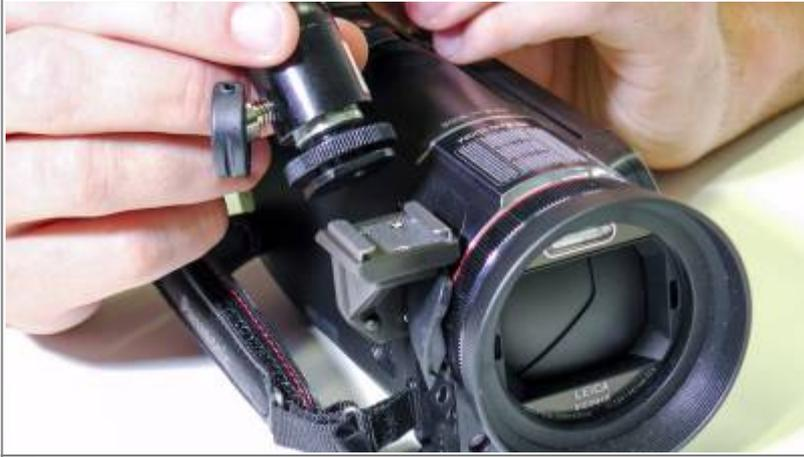
Setzen Sie das Licht mit dem Schlittenadapter auf den Schlitten an der Kamera.
