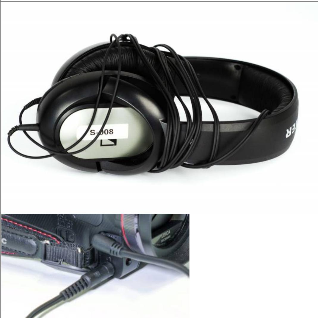
Verbinden Sie dazu den Kopfhörer mit dem anderen Klinkenanschluss der Kamera.
