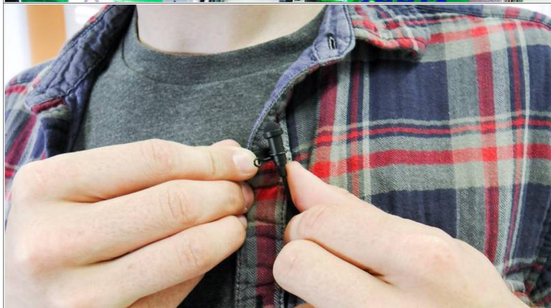
Befestigen Sie das Lavalier-Mikrofon an einem Hemd, einer Krawatte oder einer Falte im Shirt. Achten Sie darauf, dass die Kapsel am Kopf des Mikrofons nicht mit dem Stoff in Berührung kommt. Dies verursacht Störgeräusche, da das Mikrofon am Stoff kratzt. Das Mikrofon sollte in etwa zur gleichen Entfernung zum Mund, wie im Beispielbild angebracht sein.
