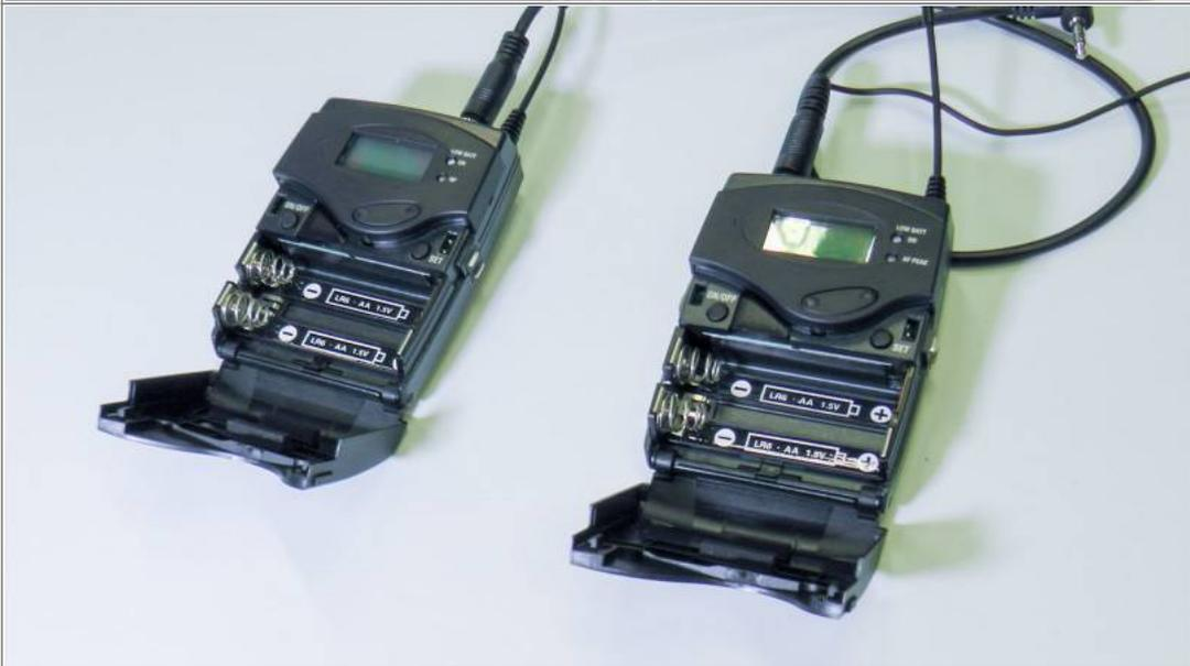
Öffnen Sie die Batteriekappen der Funkstrecken...
