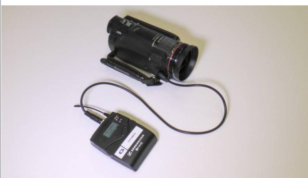
Ihre Funkstrecke ist jetzt mit der Kamera verbunden und das Audio vom Sender (dem Mikrofon) wird übertragen.
