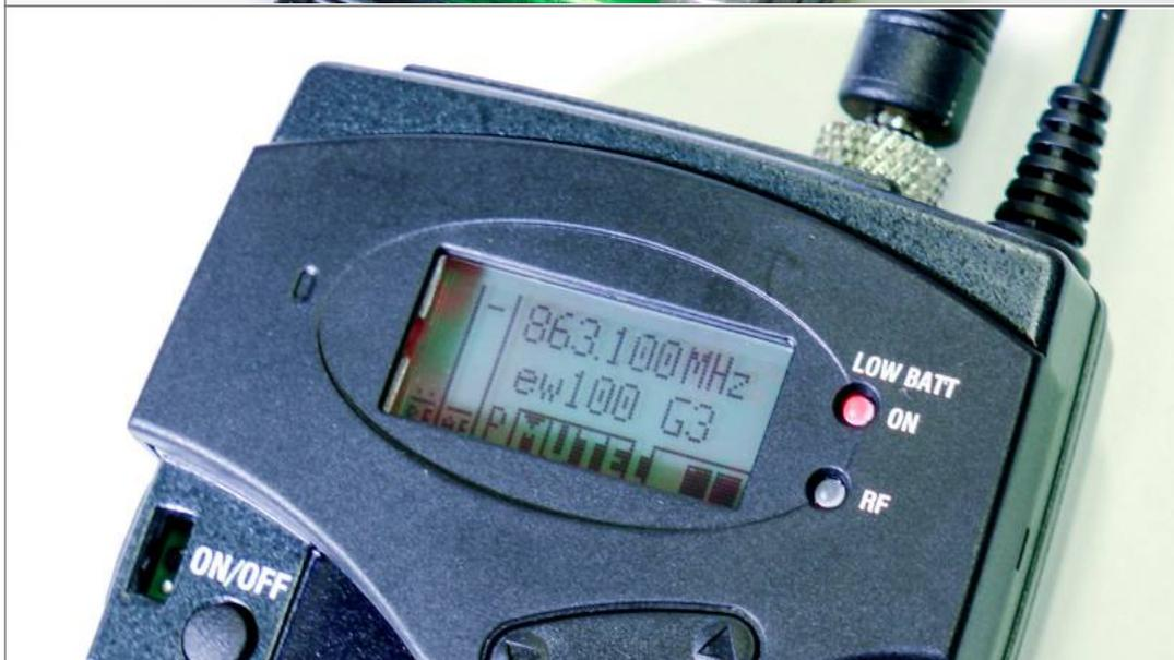
Ist das Gerät eingeschaltet, erscheint ein Display. Die Geräte sind voreingestellt und sollten bei beiden Geräten die gleiche Sendefrequenz anzeigen. Hier im Beispielbild: 863.100 MHz
