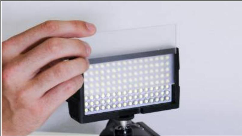
Für ein weicheres Licht (und damit weicheren Schatten) können Sie die weiße Diffusor-Scheibe einsetzen. Die Farbe des LED-Lichts entspricht Tageslicht-Weiß.
