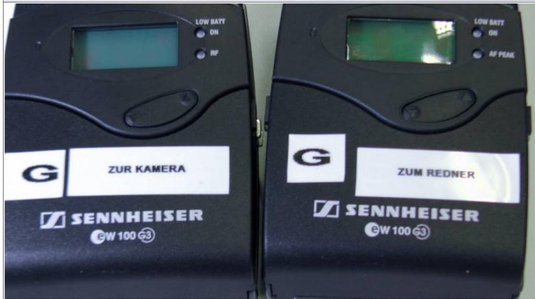
Die Funkstrecken bestehen aus einem Empfänger (Receiver), welcher an die Kamera angeschlossen wird, sowie aus einem Sender (Transmitter), an welchem das Mikrofon angeschlossen wird.
