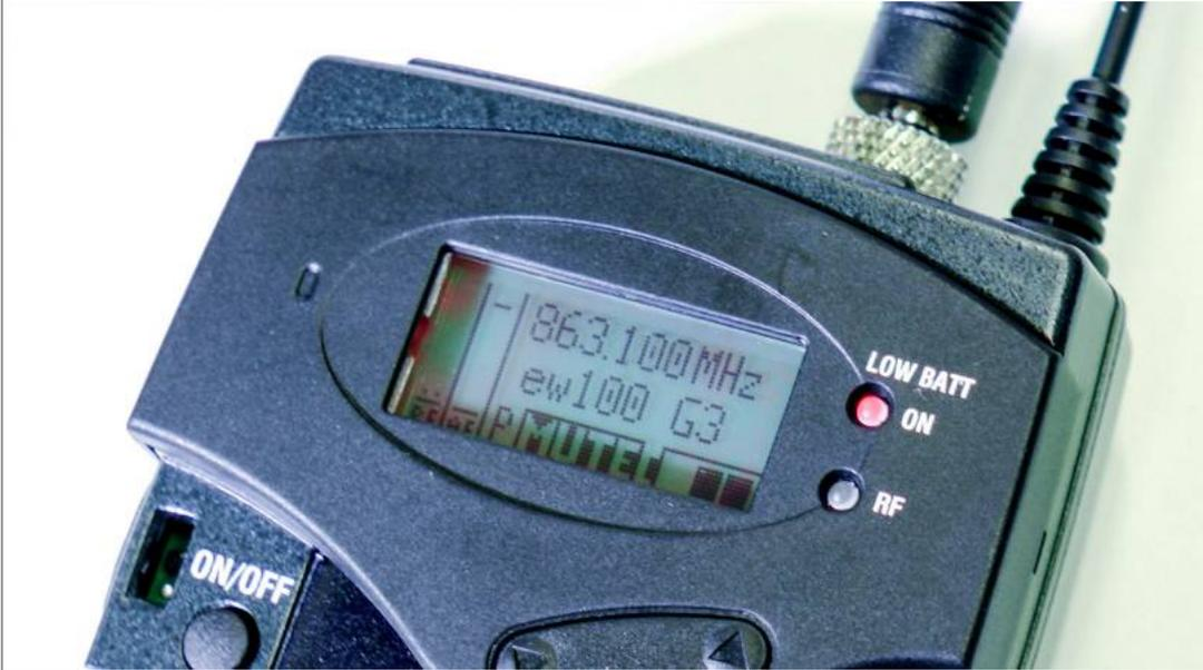
Ist das Gerät eingeschaltet, erscheint ein Display. Die Geräte sind voreingestellt und sollten auf den jeweiligen Displays die gleiche Sendefrequenz anzeigen. Hier im Beispielbild: 863.100 MHz
