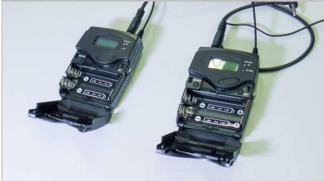
Öffnen Sie die Batteriekappen der Funkstrecken...
