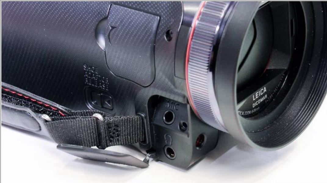
Schließen Sie den Empfänger (Receiver) mit dem Klinken-Verbindungskabel an die Kamera an. Als Eingang wählen sie den **MIC**-Klinkenanschluss.
