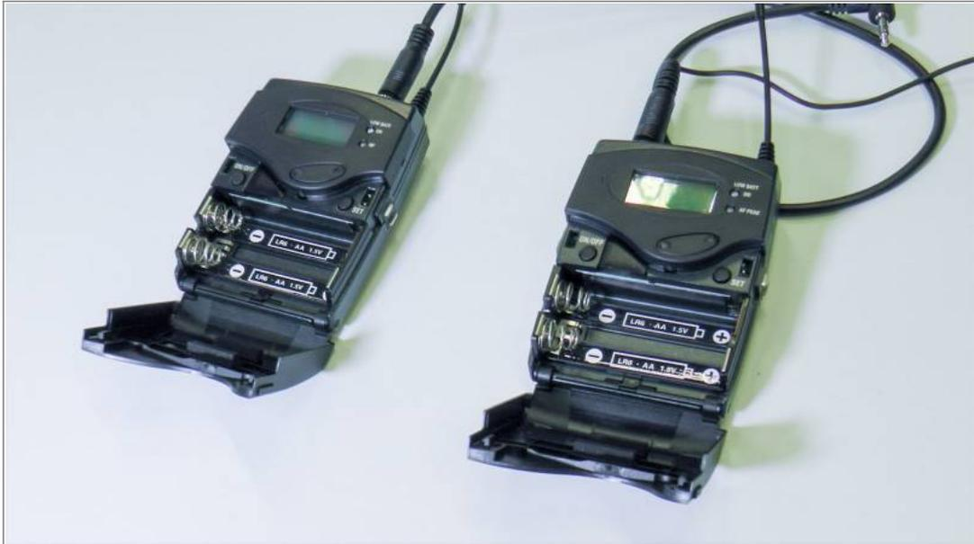
Öffnen Sie die Batteriekappen der Funkstrecken...
