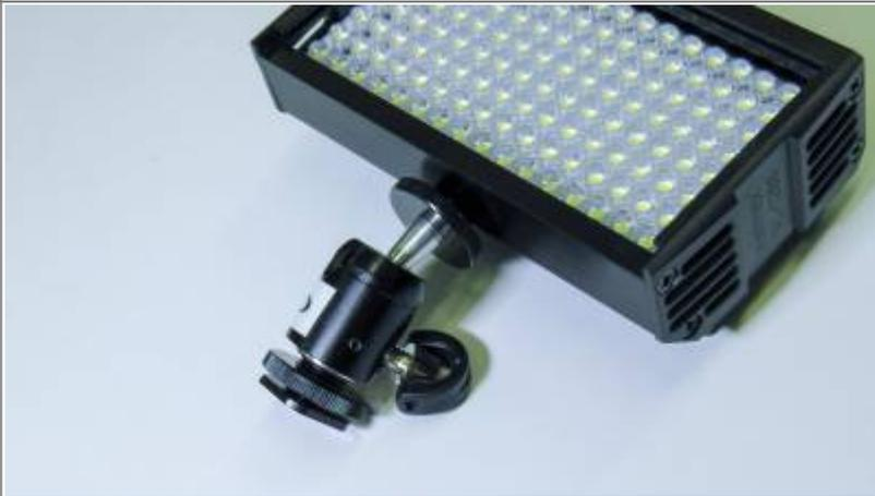
Drehen Sie die Scheibe zu, so dass sich das LED-Panel an der Schraube nicht mehr von selbst bewegen kann.
