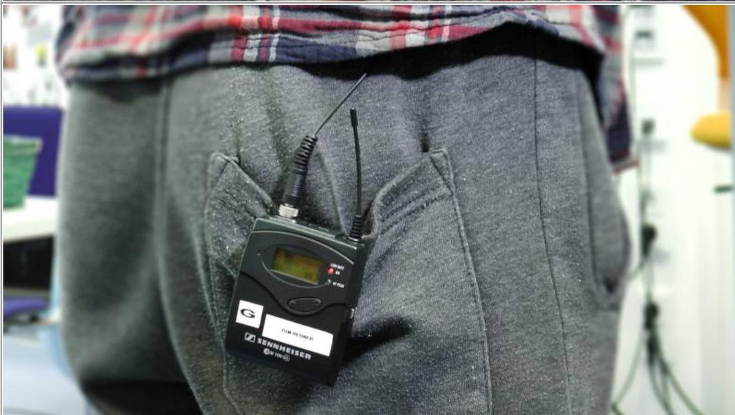
Den Klinkenstecker des Mikrofon-Kabels verbinden Sie mit dem Sender (Transmitter). Üblicherweise wird der Sender hinten am Gürtel oder an einer Hosentasche befestigt.
