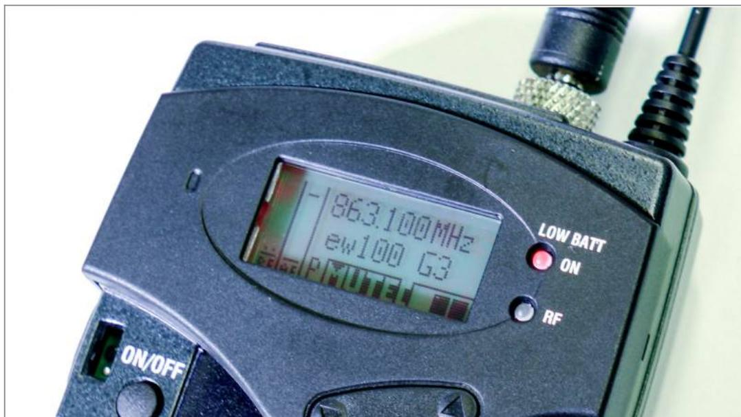
Ist das Gerät eingeschaltet, erscheint ein Display. Die Geräte sind voreingestellt und sollten auf den jeweiligen Displays die gleiche Sendefrequenz anzeigen. Hier im Beispielbild: 863.100 MHz
