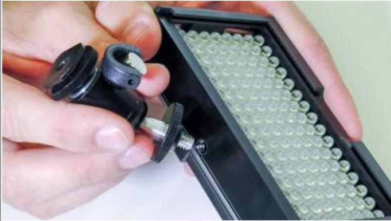
Schrauben sie den Adapter für den Schlitten an das LED-Panel.
