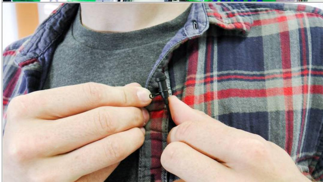
Befestigen Sie das Lavalier-Mikrofon an einem Hemd, einer Krawatte oder einer Falte im Shirt. Achten Sie darauf, dass die Kapsel am Kopf des Mikrofons nicht über den Stoff reibt. Dies verursacht Störgeräusche, da das Mikrofon am Stoff kratzt. Das Mikrofon sollte in etwa zur gleichen Entfernung zum Mund angebracht sein, wie im Beispielbild zu sehen.
