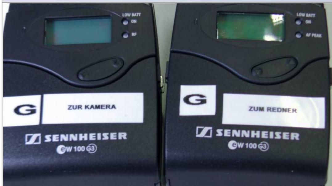
Die Funkstrecken bestehen aus einem Empfänger (Receiver), welcher mit der Kamera verbunden wird, sowie aus einem Sender (Transmitter), an welchem das Mikrofon angeschlossen wird.
