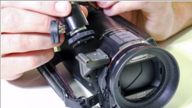
Setzen Sie das LED-Panel mit Hilfe des Schlittenadapters auf den Schlitten an der Kamera.
