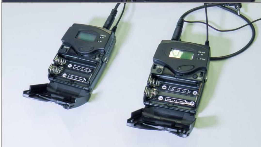
Öffnen Sie die Batteriekappen der Funkstrecken...
