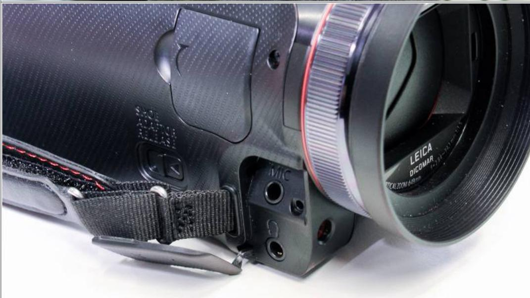
Schließen Sie den Empfänger (Receiver) mit dem Klinken-Verbindungskabel an die Kamera an. Als Eingang wählen sie den **MIC**-Klinkenanschluss.
