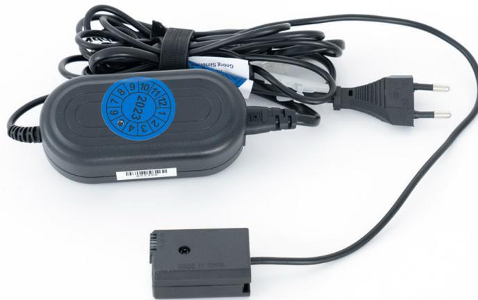
Akku-Dummy und Netzstromversorgung
