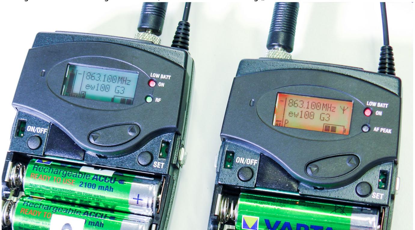
Sobald die Verbindung zwischen den Geräten hergestellt ist, verschwindet die „MUTE“-Anzeige.
