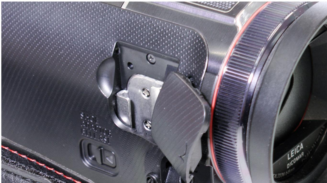
Öffnen Sie die Plastikklappe an der Kamera für den montierbaren Schlitten.
