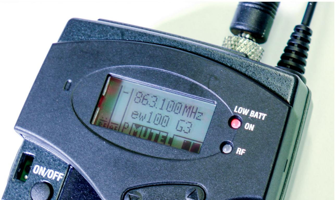
Ist das Gerät eingeschaltet, erscheint ein Display. Die Geräte sind voreingestellt und sollten auf den jeweiligen Displays die gleiche Sendefrequenz anzeigen.
