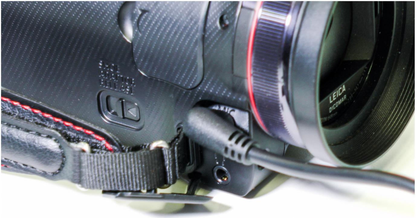
Schließen Sie den Empfänger (Receiver) mit dem Klinken-Verbindungskabel an die Kamera an. Als Eingang wählen sie den **MIC**-Klinkenanschluss.
