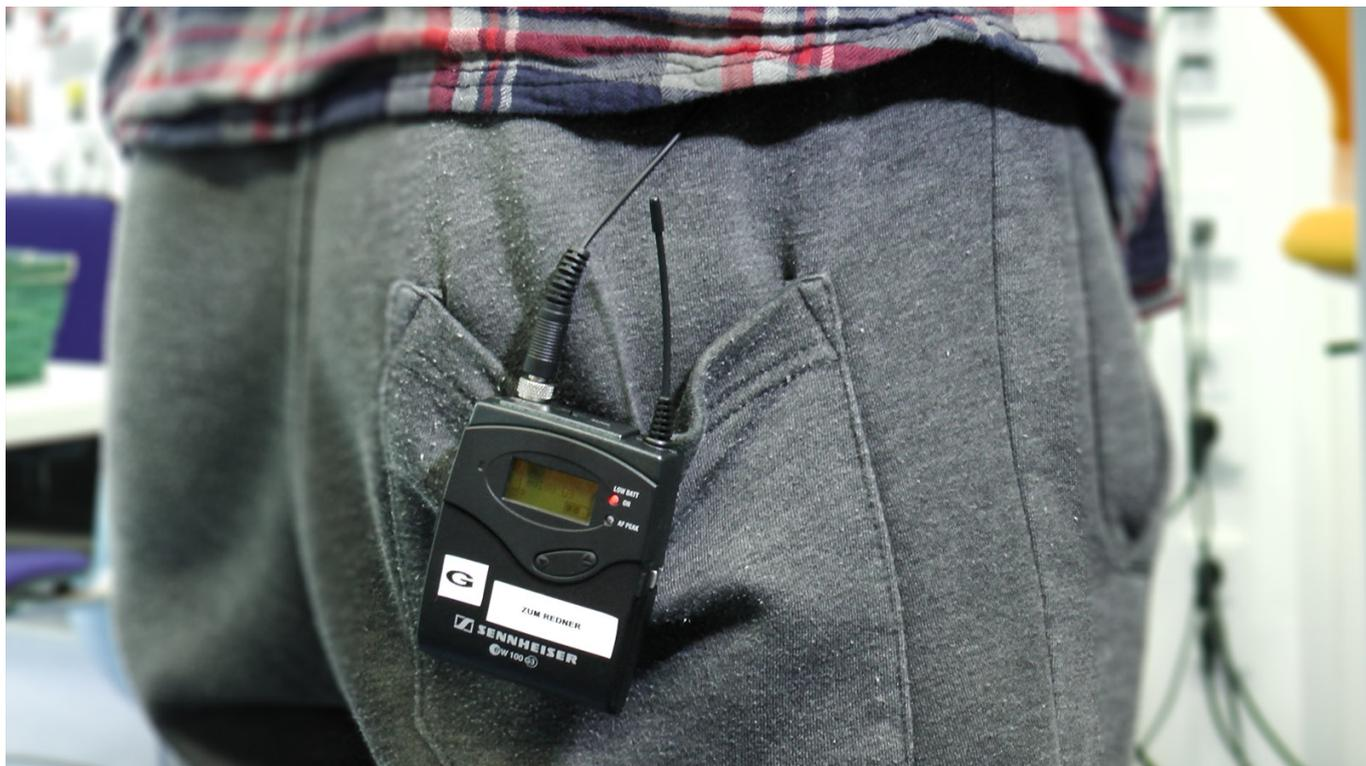
Den Klinkenstecker des Mikrofon-Kabels verbinden Sie mit dem Sender (Transmitter). Üblicherweise wird der Sender hinten am Gürtel oder an einer Hosentasche befestigt.
