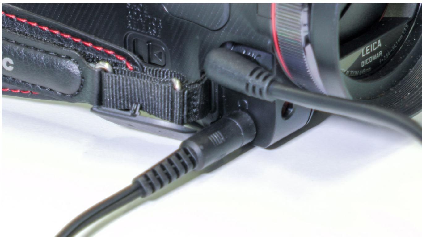
Verbinden Sie dazu den Kopfhörer mit dem anderen Klinkenanschluss der Kamera.
