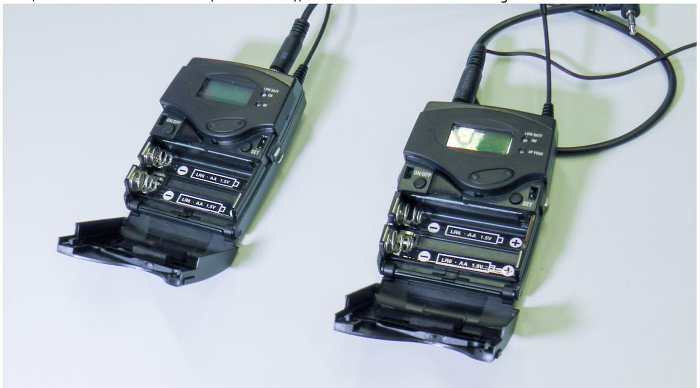
Öffnen Sie die Batteriekappen der Funkstrecken...
