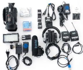
Der Medienrucksack 1 ist ein Komplettset zur semiprofessionellen Videoproduktion. Das Set umfasst neben dem Camcorder ein LED-Panel, ein Richtmikrofon und eine Funkstrecke mit Ansteckmikrofon.
